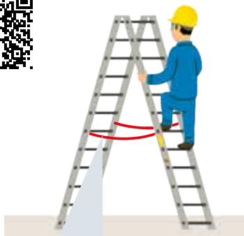
Escalera de tijera con protección de separación
