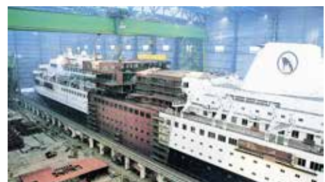
Homeric is lengthened by 40 m and renamed Westerdam Homeric wird zu Westerdam, mit 40 m Verlängerung – im Baudock auf der MEYER WERFT
