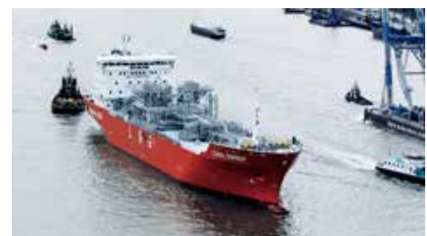
Vaporised LNG and marine diesel are used as fuel Sowohl verdampftes LNG als auch Marine-Diesel dienen als Treibstoff
